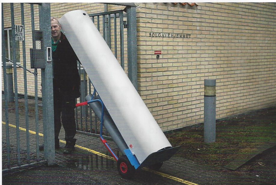
Hele sprinkleranlægget vejer blot 65 kg – uden vand – og kan flyttes på en sækketvogn. Foto: Københavns Brandvæsen.
